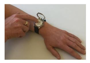
Bei einer tastbaren Armbanduhr wird das Glas aufgeklappt und die Finger tasten die Zeiger sowie die Reliefstriche auf dem Ziffernblatt behutsam ab.
