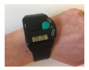
Auf Knopfdruck sagen sprechende Armbanduhren die Zeit an. Sprechende Uhren sollten so intuitiv bedienbar sein, dass ein Alarm von einer blinden Person einstellbar ist.
