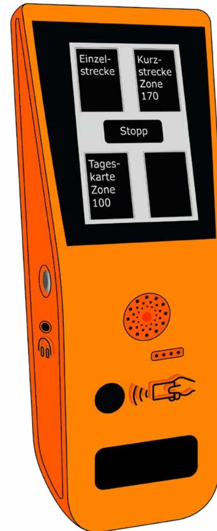
Billettautomaten mit 4-Quadranten-Modus, Sprachausgabe und taktilen Elementen entsprechen dem Mehrsinnprinzip.
